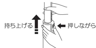
背面にある高さ調整ボタンを押してスライドパイプを持ち上げる。
