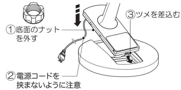
台座固定ナットを取付けしっかり締めて、スタンドを固定します。
