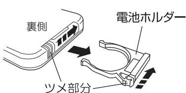
2 電池を正しい向きにセットし、リモコン本体に差し込みます。
