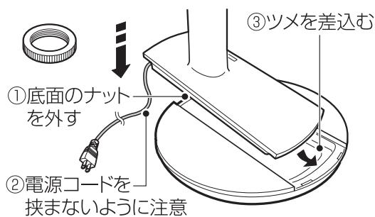
台座固定ナットを取り付けしっかりと締めて、スタンドを固定します。
