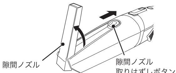
②吸込口に押し込んで、隙間ノズルを固定します。
