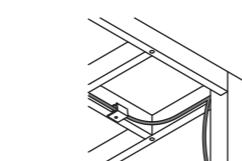
電源コードを固定せずに使用すると、断線やショートを引き起こし、火災や感電、故障の原因になります。
