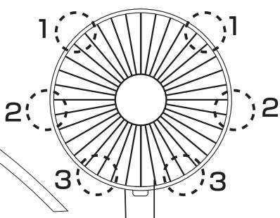
3. クリップを強く押し込み、しっかりと固定します。
