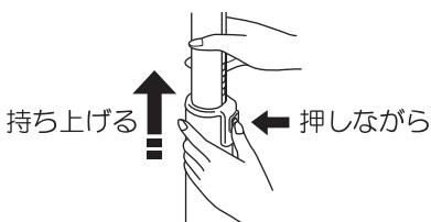
背面にある高さ調整ボタンを押してスライドパイプを持ち上げる。
