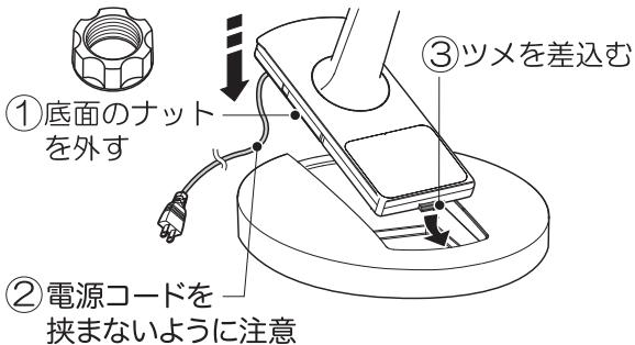
台座固定ナットを取り付けしっかりと締めて、スタンドを固定します。
