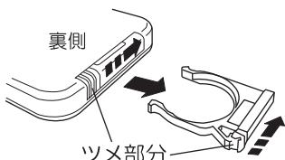
2 電池を正しい向きにセットし、リモコン本体に差し込みます。
