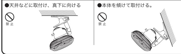
●壁に固定する場合は、丈夫で垂直な板壁または柱などにネジを打付けてクリップ部の穴に引掛けて取付けてください。
