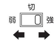
●羽根の回転を停止させるには、スイッチを『切』の位置にスライドさせるとすべての運転が停止します。
