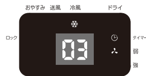
(例) 冷風運転・風量弱・ タイマー時間 3 時間の場合
